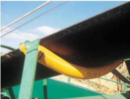
Se caracterizan por su elevada capacidad elástica y de amortiguación. Reducen el impacto y alargan de forma considerable la vida de la banda. Su elasticidad permite aumentar la capacidad de transporte de un 20 a un 30%.
